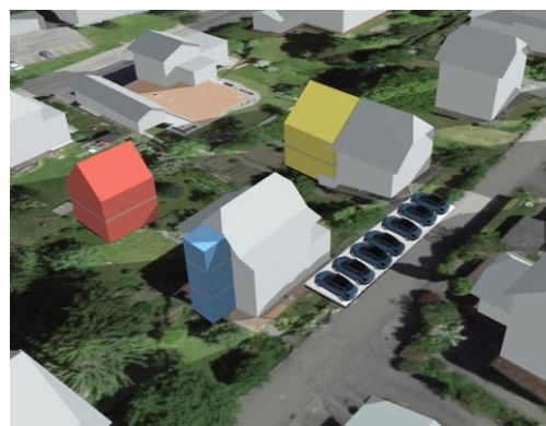
Anbauten (gelb), Neubauten (rot), Erschliessungsblöcke (blau)
